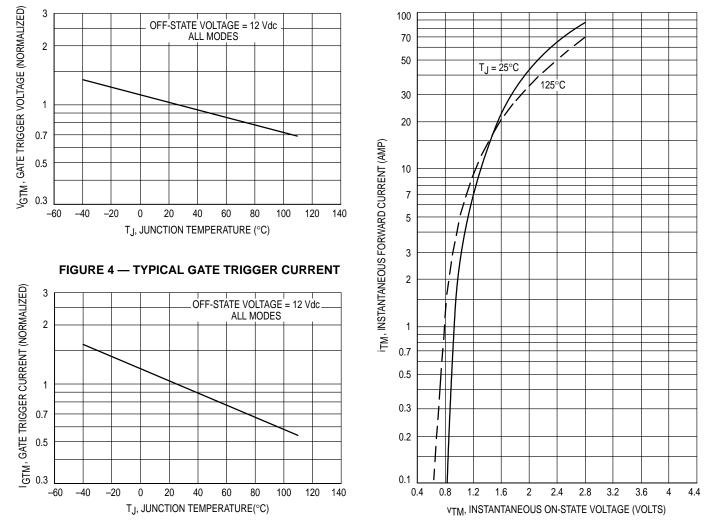
FIGURE 3 — TYPICAL GATE TRIGGER VOLTAGE
